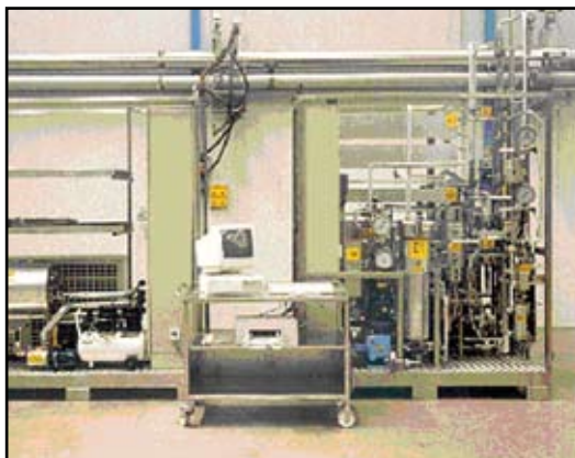
Figura 1. Configurazione di un impianto pilota di estrazione da 5 litri
